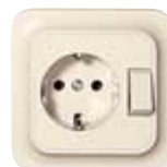
SCHUKO® -wandcontactdoos met wisselschakelaar Passend in 60er inbouwdozen. Voor schroefbevestiging, zonder klauwen. Met schroefklemmen. Wandcontactdoos: 16 A, AC 250 V, DIN 49440 Wisselschakelaar: 16 A, AC 250 V
