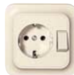
SCHUKO® -wandcontactdoos met wisselschakelaar Passend in 60er inbouwdozen. Met schroefklemmen. Wandcontactdoos: 16 A, AC 250 V, DIN 49440 Wisselschakelaar: 16 A, AC 250 V
