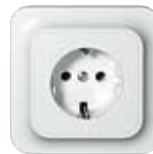
SCHUKO® -wandcontactdoos met schroefklemmen 16 A, AC 250 V, DIN 49440
