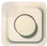
Dimmer met druk-wisselschakelaar voor ohmse last AC 230 V Voor schroefbevestiging, zonder klauwen. Voor gloeilampen en 230 V halogeenlampen. (faseaansnijding).
